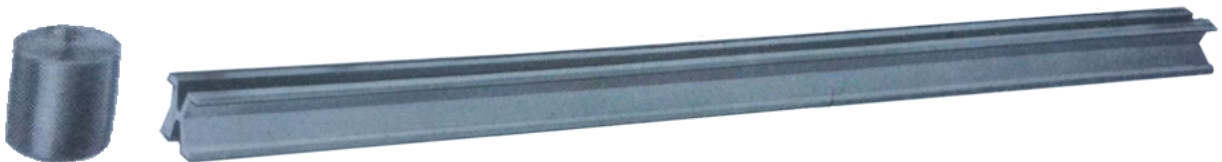
Immagine del chilogrammo campione e del metro campione
